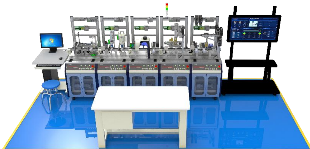
工业互联网工程应用技术平台总布局示意图
